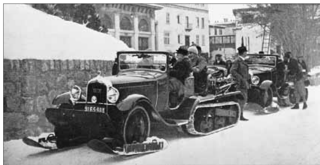
Due «Autochenilles» davanti all'hotel Kulm che rendono possibile e persino confortevole l'attraversamento invernale del passo dello Julier innevato. (Foto Archiv Badrutt's Palace Hotel, St. Moritz)
